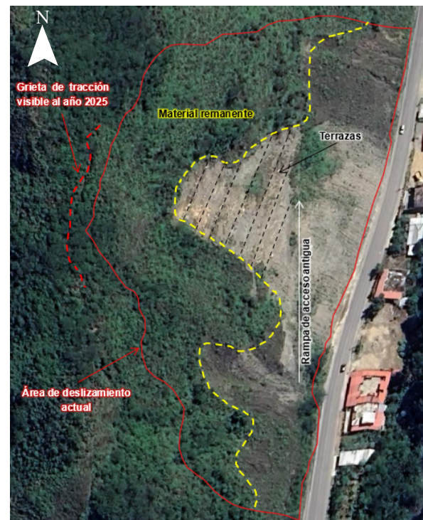
Figura 3: Vista en planta del área de estudio sobre fotografía aérea con fecha 03-04-2024 [29]. Se delimita el área de afectación previa mediante una línea amarilla y el área asociada al evento actual mediante una línea roja continua.
