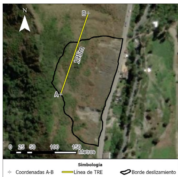
Figura 5: Ubicación en planta y extensión A-B de la línea de prospección TRE en el talud afectado.
