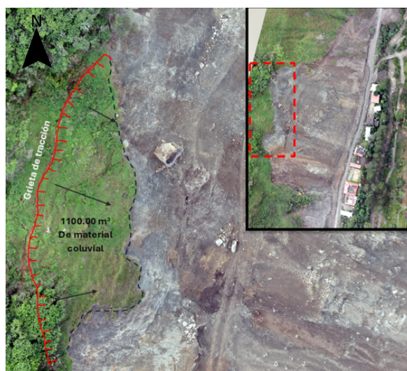
Figura 24: Vista en planta, grieta de tracción visible en ortofoto con fecha 08-06-2025.
