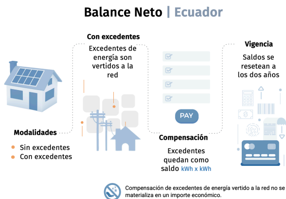
Figura 2. Funcionamiento “balance neto” en Ecuador.
