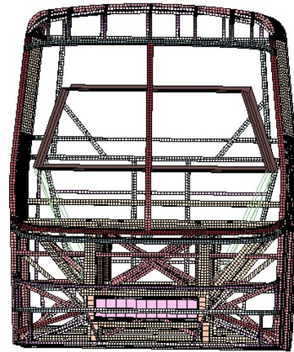
Figura 4. Modelo matemático correspondiente a la estructura completa.
