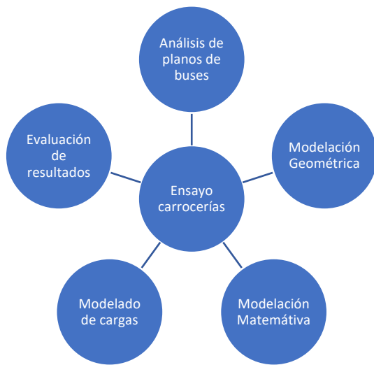
Figura 1. Metodología de ensayo estructural de autobuses
