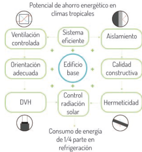
Figura 12: Estrategias para el potencial de ahorro energético en climas tropicales cálidos Fuente: elaboración propia.
