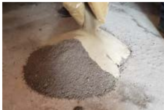
Figura 6. Preparación de la mezcla para la fabricación de adoquines
