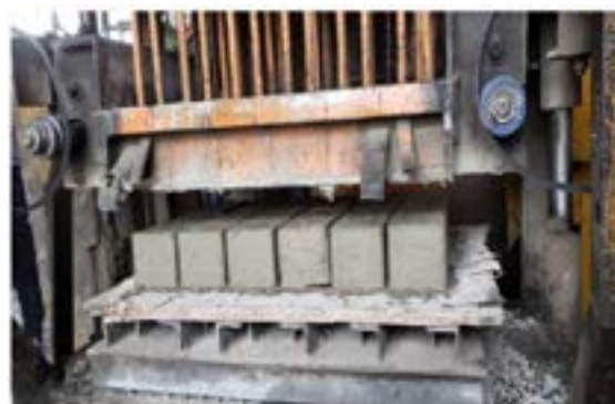
Figura 7. Fabricación de adoquines en prensa de gatos hidráulicos
