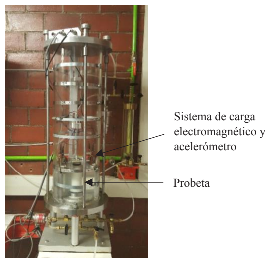
Figura 3: Equipos de laboratorio: cámara triaxial cíclica (arriba) y columna resonante (abajo).
