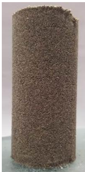
Figura 2: Probeta compactada por el método húmedo
